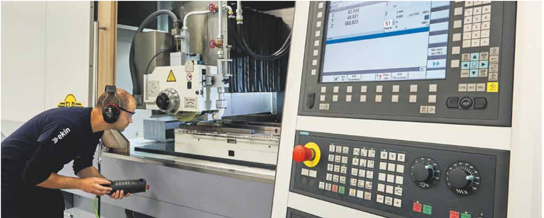
Alikona markako 3Dko zehaztapen handiko mikroskopioa du, lehenengoa estatuan; horrela piezaren argazki mikroskopikoa ateratzen da eta bere alderaketa automatikoa CDA-CAM dokumentuagaz.
